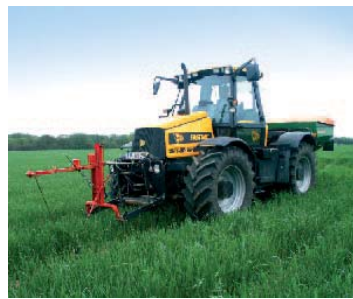
Abb. 1: Ein Kamerasensor steuert „online“ die auszubringende Menge an Pflanzenschutzmitteln. (Foto: ATB)
